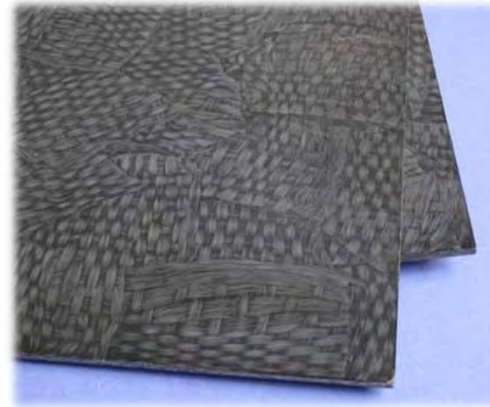
Plaques issues de la technologie Thermosaïc® Source : Cetim-Cermat
